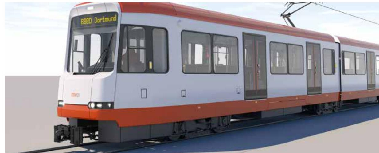
Als besonderer Clou rundet die Fahrzeugabsenkung über eine Luftfederung – ähnlich wie bei Bussen – das Gesamtpaket ab.
